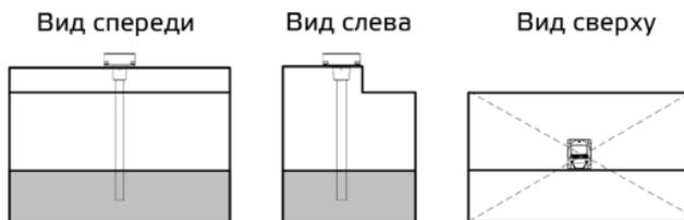
Рисунок 1. Выбор места установки датчика Omnicomm LLS 5
